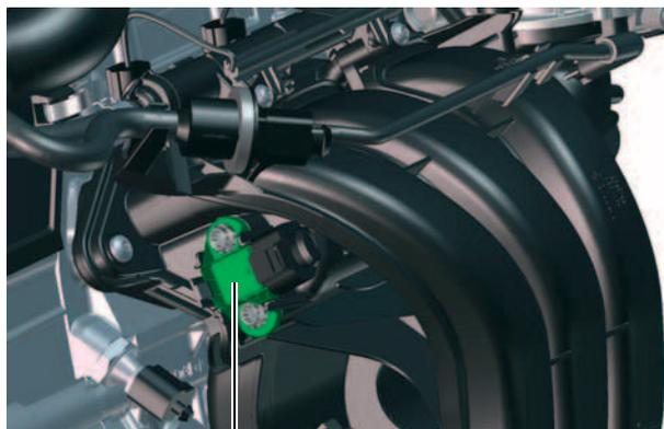
Датчик давления во впускном коллекторе G71 с датчиком температуры воздуха на впуске G42
