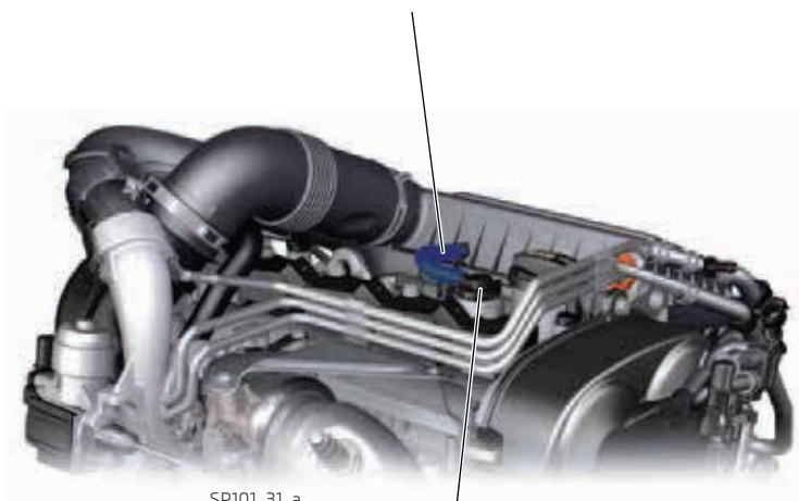
Место подсоединения шланга к воздушному фильтру
